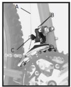
Figure 21- Front derailleur A- Cable
